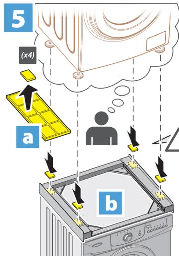
IT Se i piedini dell'asciugatrice non appoggiano correttamente su "Torre Square L60" rimuoverli; applicate i rettangoli adesivi nella posizione più idonea e verificate che l'asciugatrice si appoggi stabilmente.
