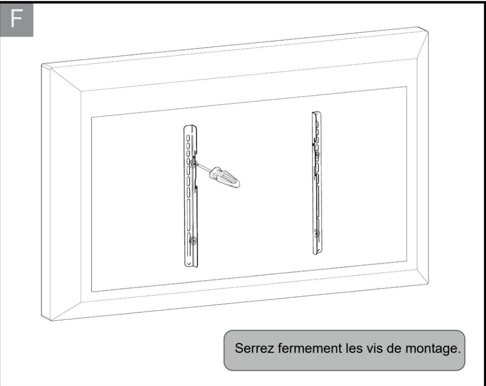
Serrez fermement les vis de montage.
