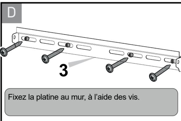
3 Fixez la platine au mur, à l'aide des vis.
