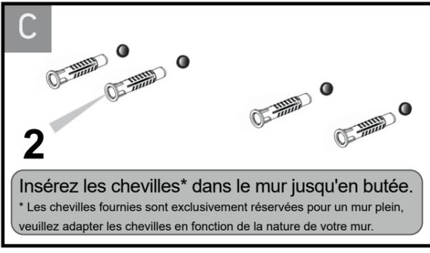
2 Insérez les chevilles\* dans le mur jusqu'en butée.
